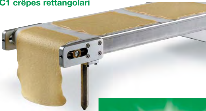
1 Particolare rullo riscaldatore C1 crêpes rettangolari
